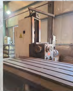
端面铣床 Face Milling Machine 产地:南通京鼎 型号 (Model) :X1580 工作行程(Platform):2000×800 数量 (Quantity) :1台
