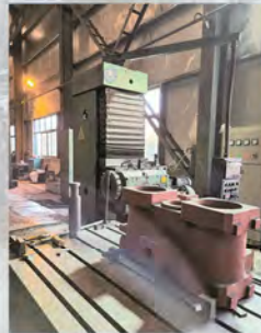
端面铣床Face Milling Machine 产地:江西江重 型号 (Model) :X338A 工作行程(Platform):2000×800 数量 (Quantity) :1台
