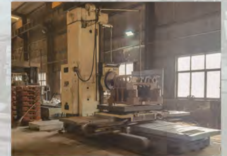
镗床Boring Machine 产地:交大昆机 型号 (Model) :TX6113C/2 工作行程(Platform):2000×1800×2000 数量 (Quantity) :1台
