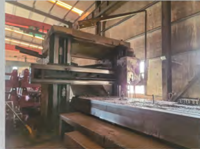
龙门铣床Milling Machine 产地:俄罗斯 型号 (Model) :MC6203 工作行程(Platform):4500×2000×1500 数量 (Quantity) :1台
