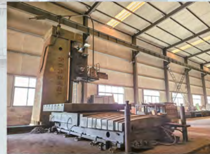
落地镗床Boring Machine 产地:武重 型号 (Model) :TX6216C 工作行程(Platform):3000×2000 数量 (Quantity) :1台
