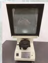
冲击试样缺口 投影仪 Impact Sample Notch Projector
