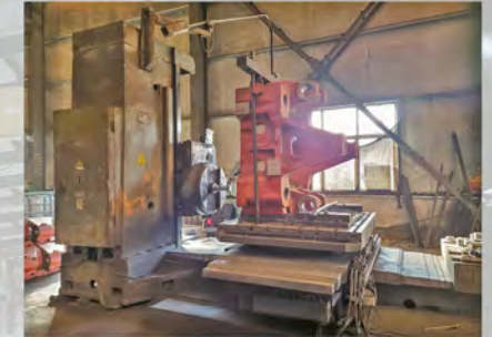
镗床Boring Machine 产地:中捷 型号 (Model) :TPX6113 工作行程(Platform):2000×1600×2000 数量 (Quantity) :2台
