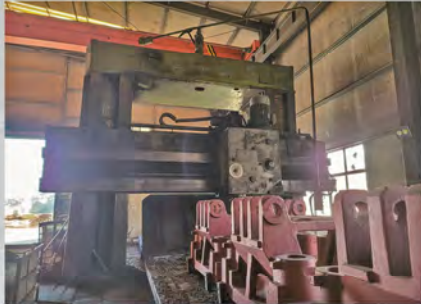
龙门铣床Milling Machine 产地:俄罗斯 型号 (Model) :MC6303 工作行程(Platform):5000×2500×2000 数量 (Quantity) :1台
