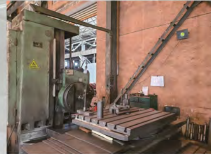
镗床Boring Machine 产地:中捷 型号 (Model) :TPX6111B 工作行程(Platform):1200×900 数量 (Quantity) :2台
