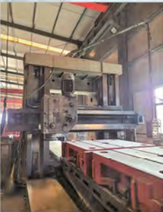
龙门铣床Milling Machine 产地:北京第一机床厂 型号 (Model) :X2012C 工作行程(Platform):3500×1250×1000 数量 (Quantity) :2台
